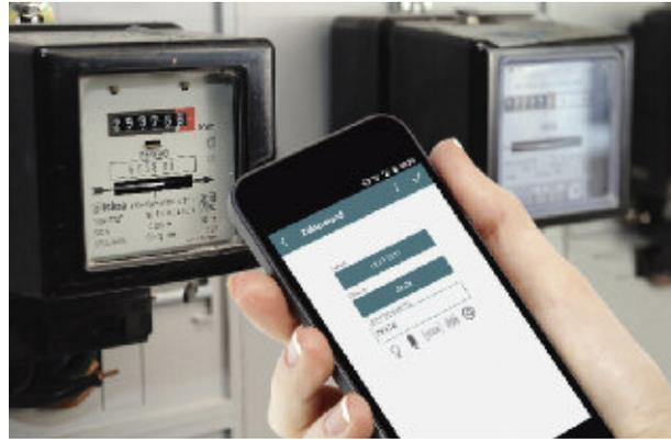
Abbildung 11: Energiespar-Apps wie der „EnergieCheck“ von cozonline, können bei der Verbrauchskontrolle hilfreich sein. Sie errechnen unter anderem aus den fotografierten Zählerständen den Verbrauch.
