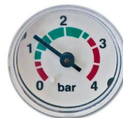
*Das Manometer zeigt den Druck in der Heizungsanlage an. Dieser sollte im grünen Bereich liegen.*
