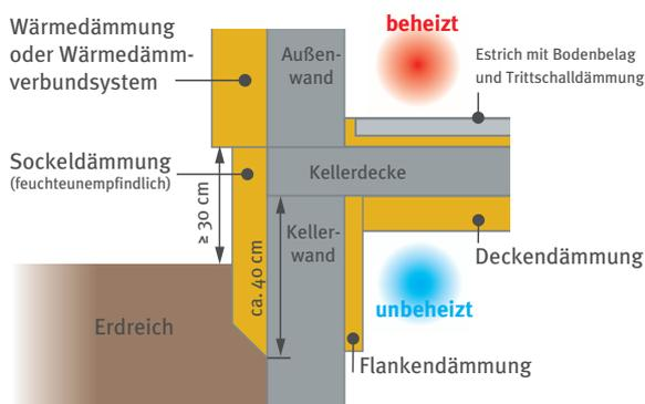
Wärmebrücken reduzieren im Sockelbereich, Schematische Darstellung
