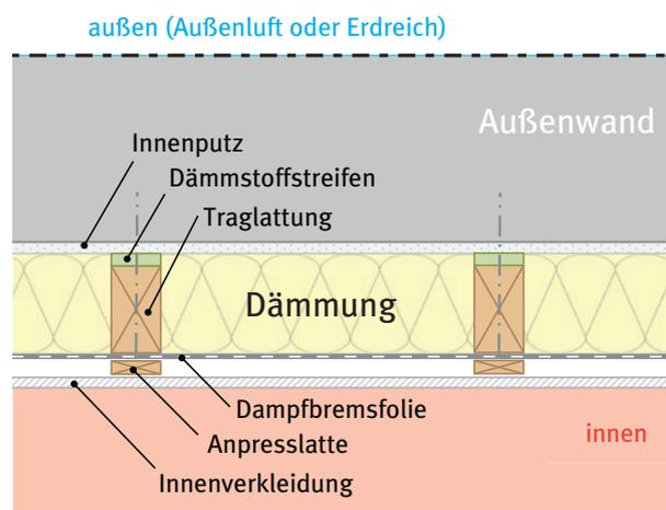
Beispiel für Dämmung mit Vorsatzschale
