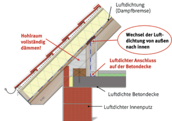
Traufe – Luftdichtung oberhalb der Sparren
