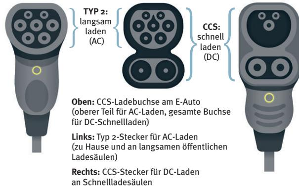
autos bei 11 oder 22 kW. Einige Kleinwagen können nur einphasig mit max. 3,7 bzw. 7,4 kW laden. Die maximale Gleichstrom-Ladeleistung an Schnellladesäulen ist modellabhängig und kann von 30 kW bis über 200 kW betragen.
