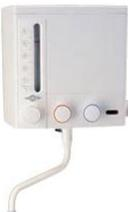
Elektrisches Kochendwassergerät zur Heißwasserbereitung oberhalb einer Küchenspüle. Das Gerät wird bedarfsgerecht mit 0,2 bis 5 Liter Wasser gefüllt und heizt auf Knopfdruck den Wasserinhalt auf die gewählte Temperatur zwischen ca. 37 °C und dem Kochpunkt auf. Nach dem Aufheizevorgang schaltet das Gerät automatisch ab oder hält bei Einstellung auf Stufe 3 das Wasser auf dem Kochpunkt. Über die Bedienelemente wird das Heißwasser entnommen und kann mit Kaltwasser gemischt werden.
